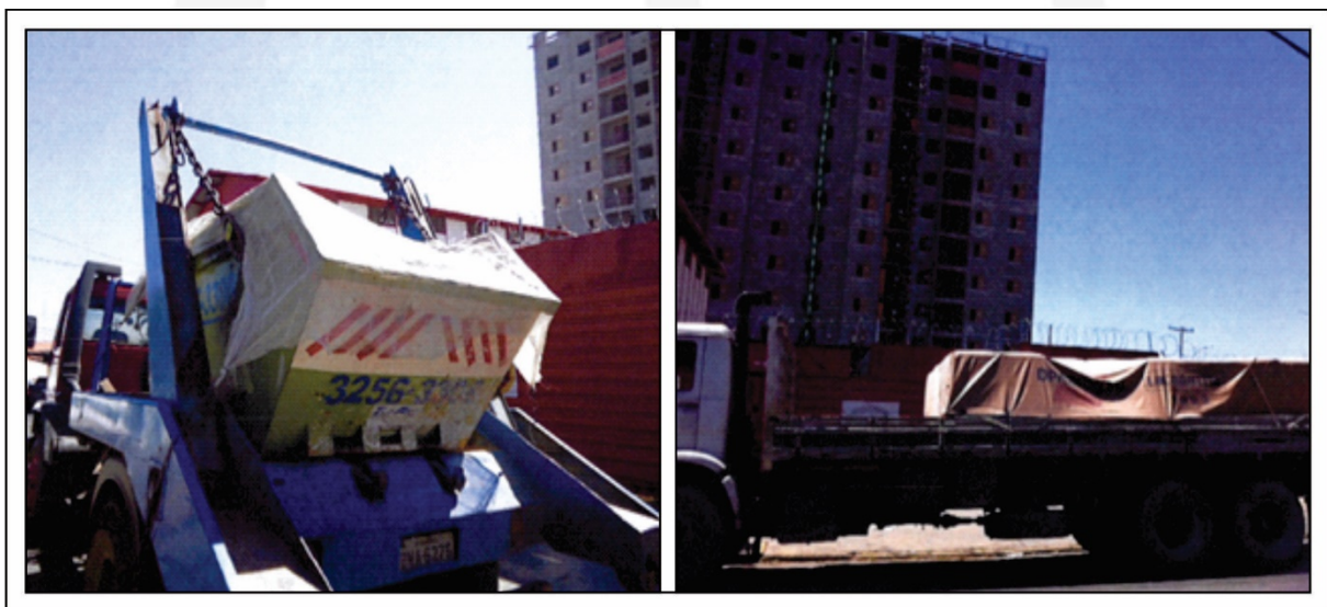
Figura 24. Exemplos de “lonamento” em caçamba de entulho e caminhão. Fonte: Global Vias.
