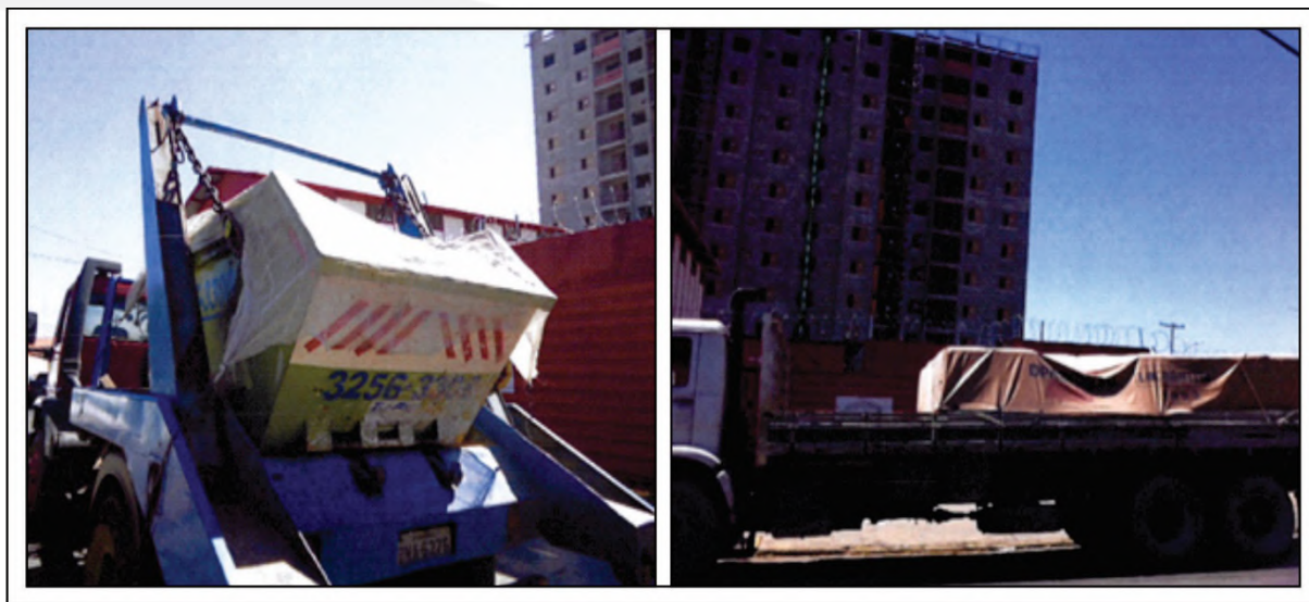
Figura 23. Exemplos de “lonamento” em caçamba de entulho e caminhão. Fonte: Global Vias.
