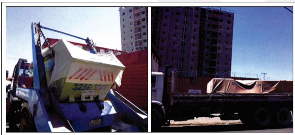
Figura 12. Exemplos de “lonamento” em caçamba de entulho e caminhão. Fonte: Global Vias.
