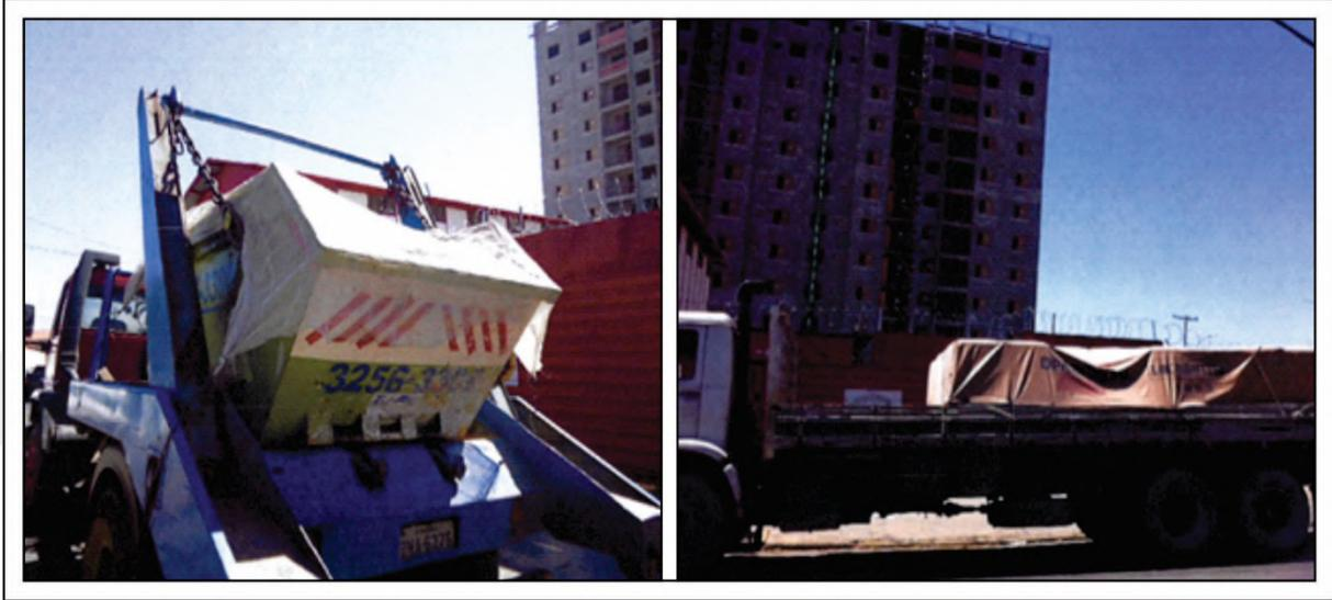
Figura 21. Exemplos de “lonamento” em caçamba de entulho e caminhão.
