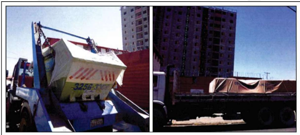
Figura 25. Exemplos de “lonamento” em caçamba de entulho e caminhão.
