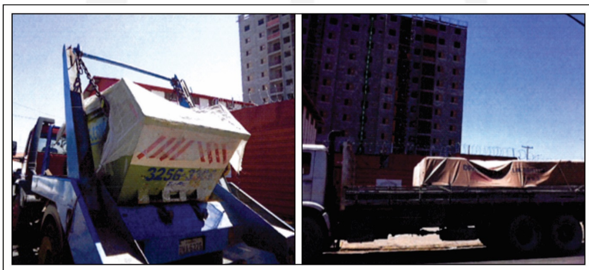
Figura 36. Exemplos de “lonamento” em caçamba de entulho e caminhão. Fonte: Global Vias.
