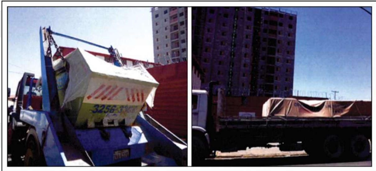
Figura 14. Exemplos de “lonamento” em caçamba de entulho e caminhão. Fonte: Global Vias.
