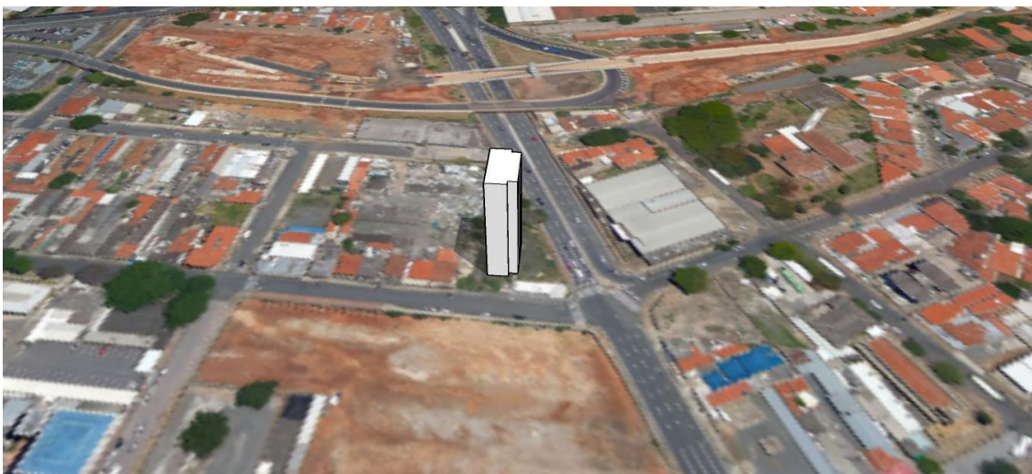
Figura 42: Simulação do sombreamento em 21 de março às 12h.
