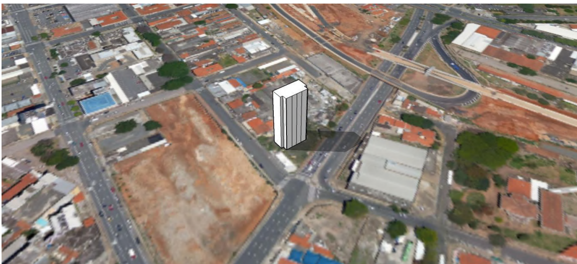
Figura 50: Simulação do sombreamento em 21 de dezembro às 09h.
