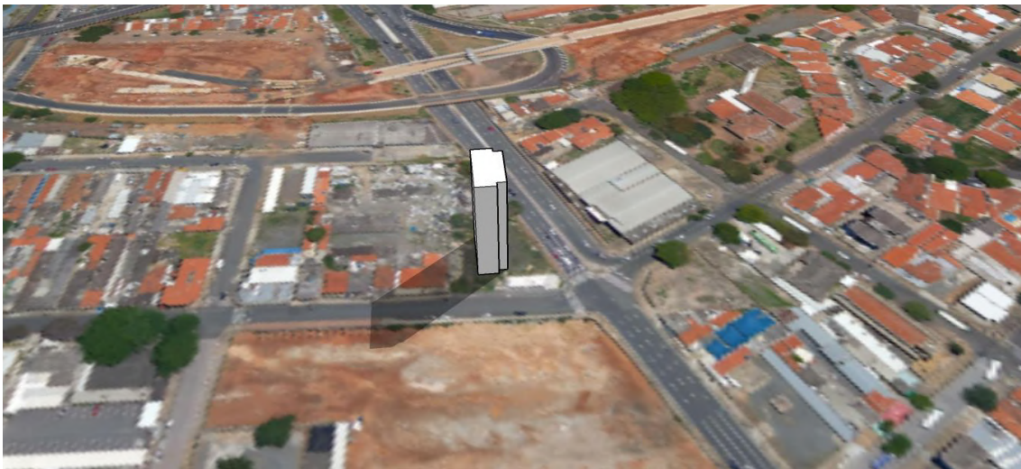
Figura 49: Simulação do sombreamento em 21 de setembro às 15h.
