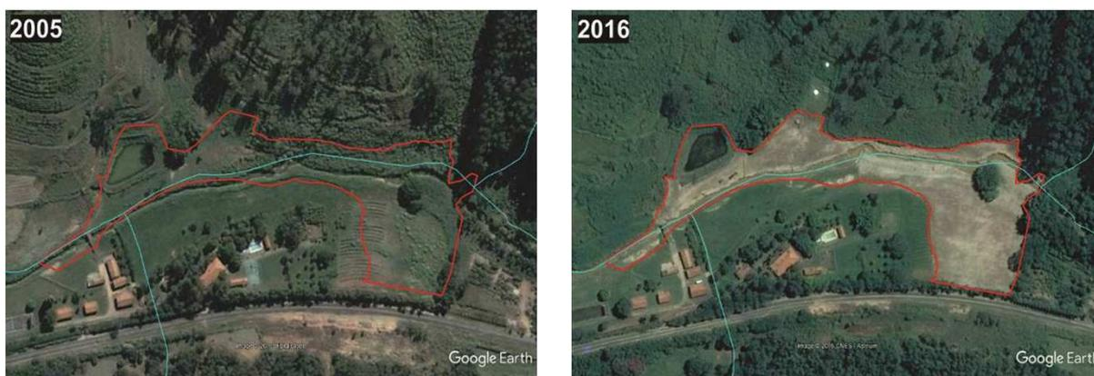
**Figura 6 - Comparação das imagens de satélite dos anos de 2005 e 2016, indicando a área de extração de granito da construtora COWAN.**
