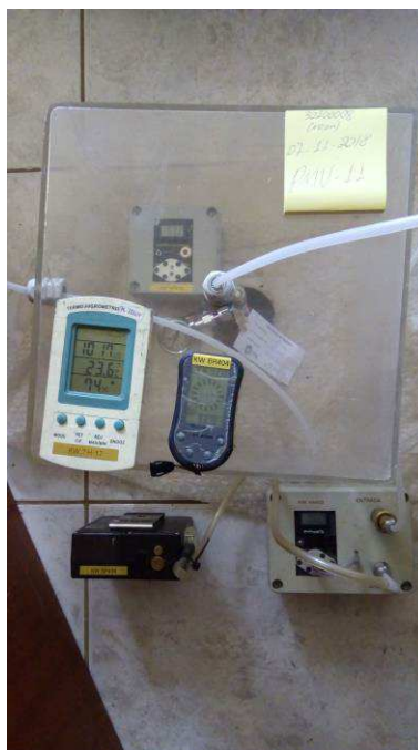
Figura 2. Posicionamento do Shroud e dos demais equipamentos para execução de teste de estanqueidade utilizando gás Hélio.
