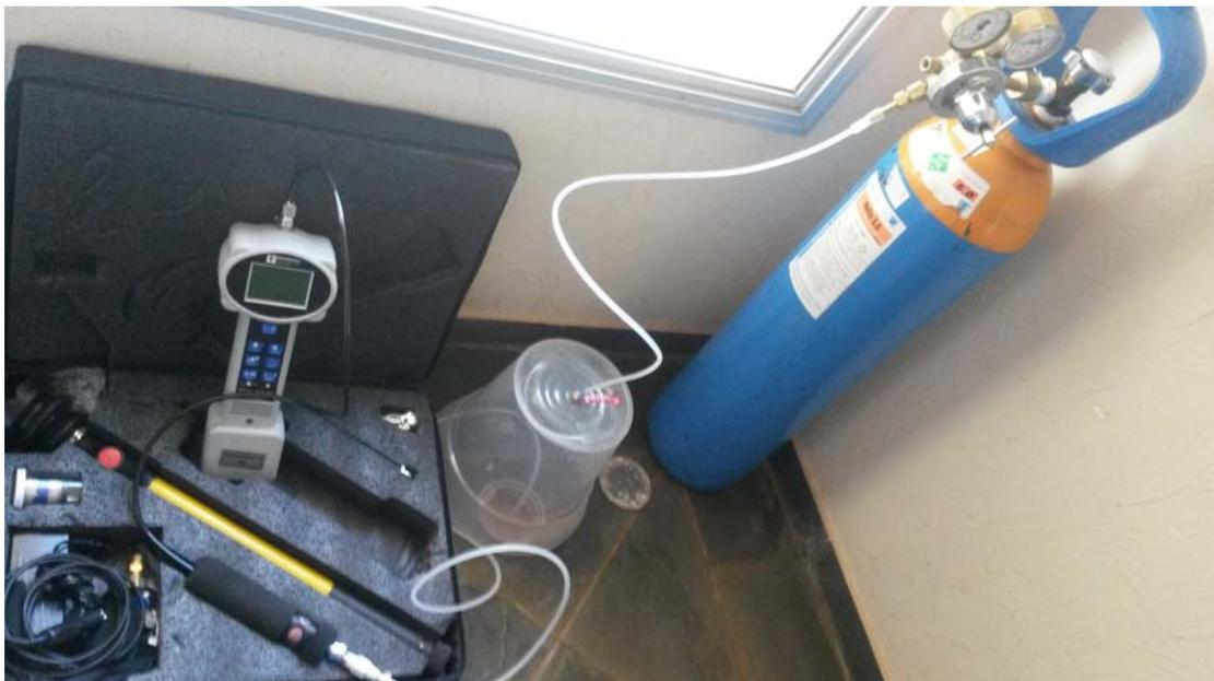
**Figura 4** – Teste de Estanqueidade nos Poços de Monitoramento de Vapor
