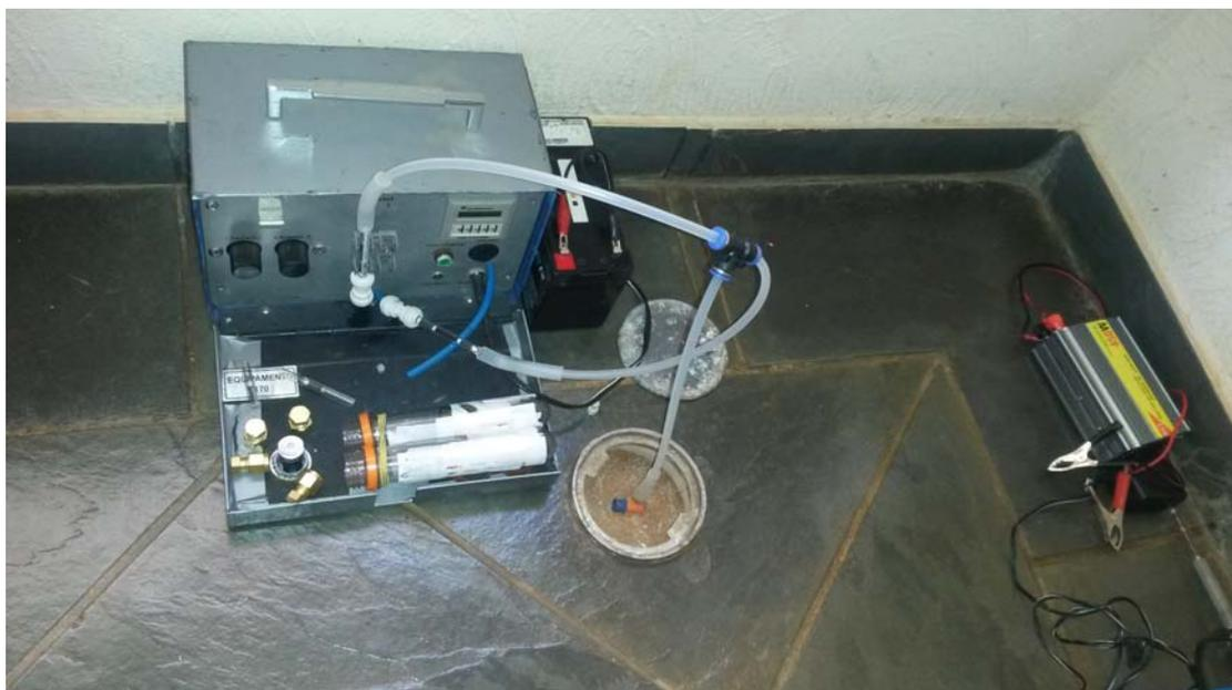
**Figura 6** – Amostragem pelo Método TO-17 nos poços de monitoramento de vapor (sub-slab)
