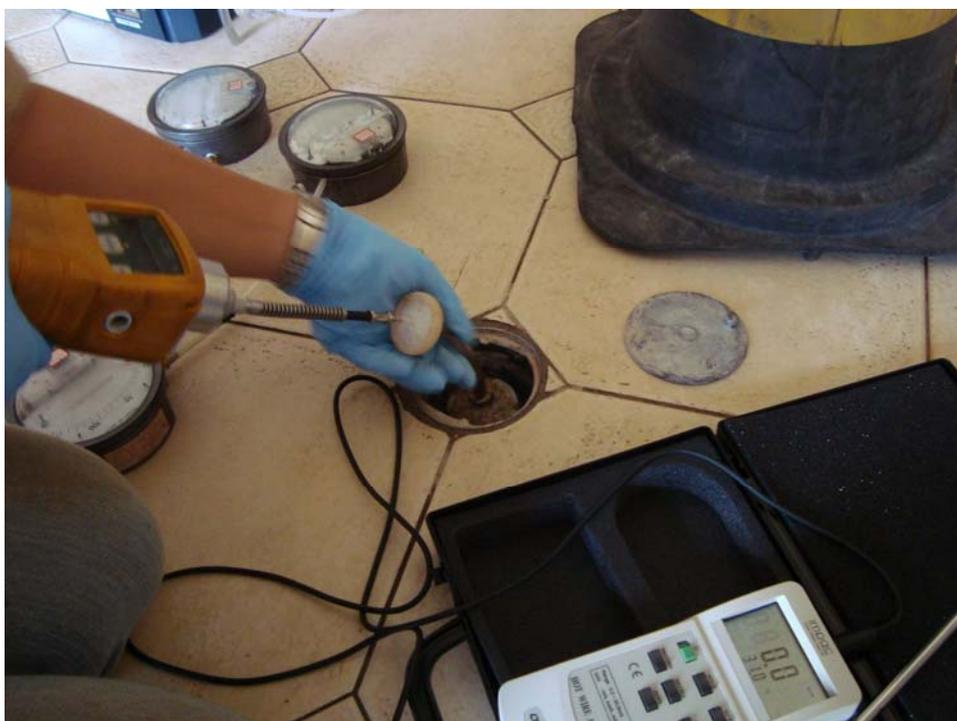
**Figura 2** – Medição de VOC (ppm) nos Poços de Monitoramento de Vácuo
