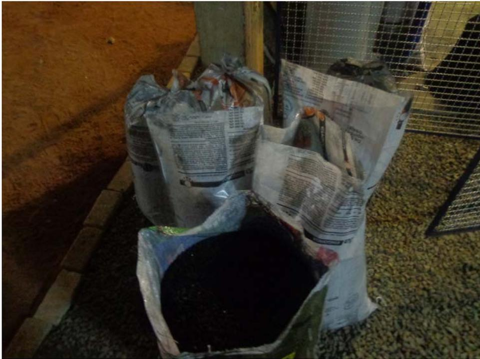
**Figura 7** – Carvão Ativado Utilizado nos Filtros de Sistema Emergencial de Extração de Vapores
