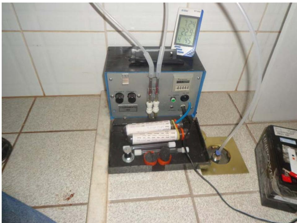
**Figura 5** – Amostragem pelo Método TO-17 nos poços de monitoramento de vapor (sub-slab)
