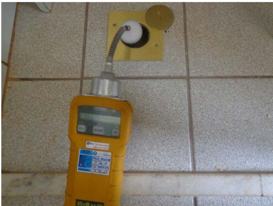
**Figura 1** – Medição de VOC (ppm) nos Poços de Monitoramento de Vapor (sub-slab)
