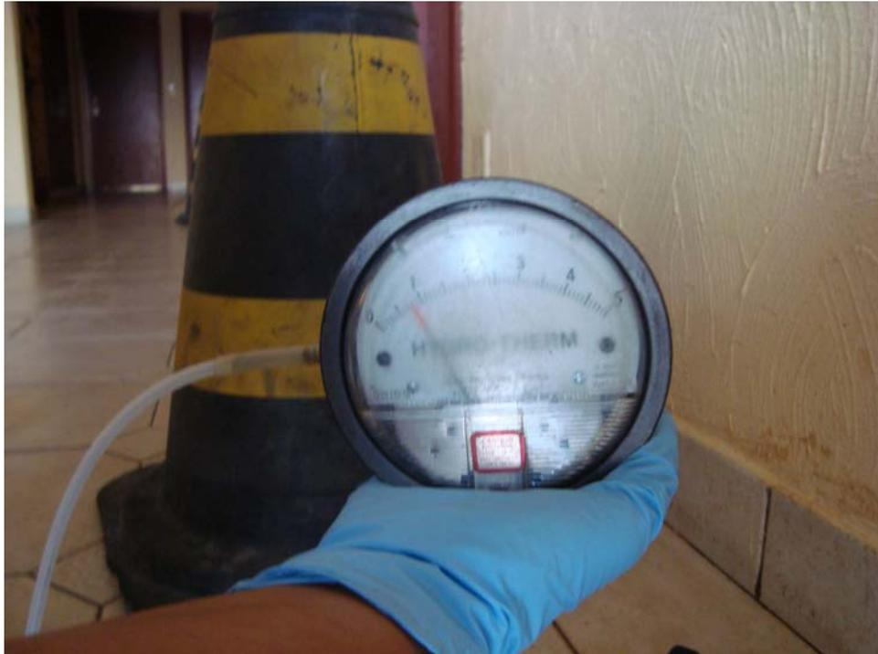
**Figura 3** – Medição de Vácuo nos Poços de Monitoramento de Vácuo
