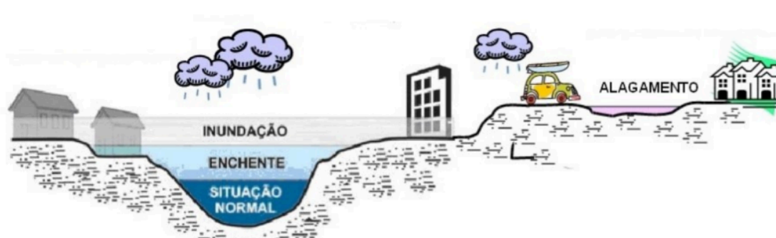
Figura 6 : Ilustração de inundação e alagamento. Fonte: Berns, 2017.
