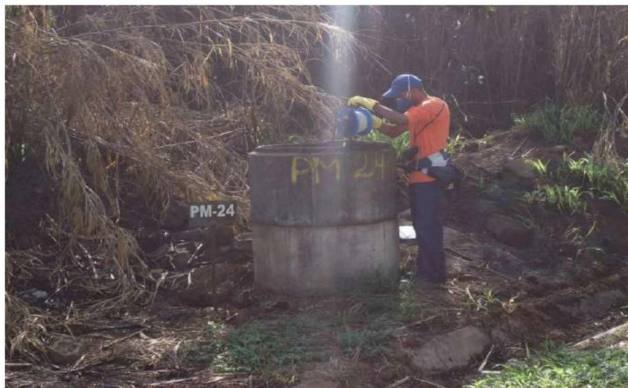
**Figura 6.110: Poços de monitoramentos das águas subterrâneas.**
