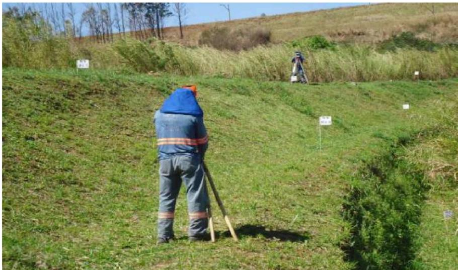
**Figura 6.117: Sistema Vertical Green – leitura dos marcos superficiais de deslocamento.**
