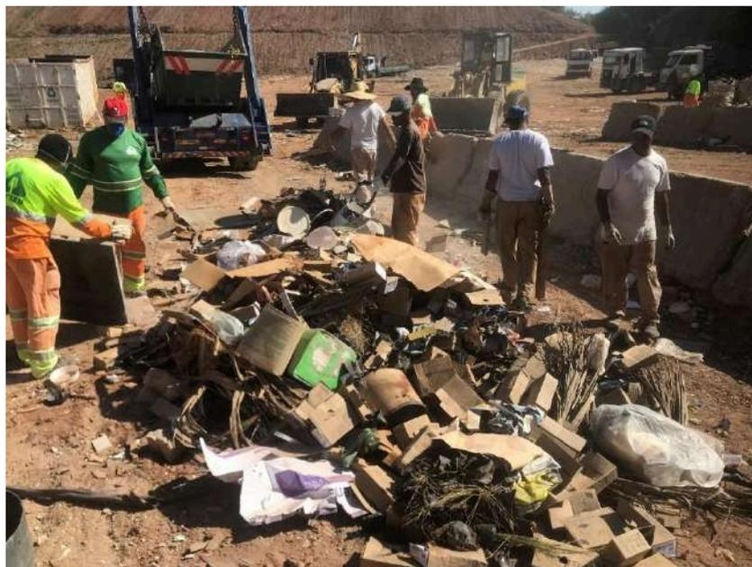
Figura 6.42: Parte operacional da triagem para o estudo gravimétrico.
