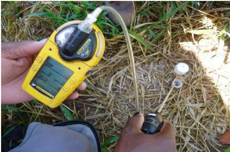
**Figura 6.105: Monitoramentos de gases e vapores – poços.**
