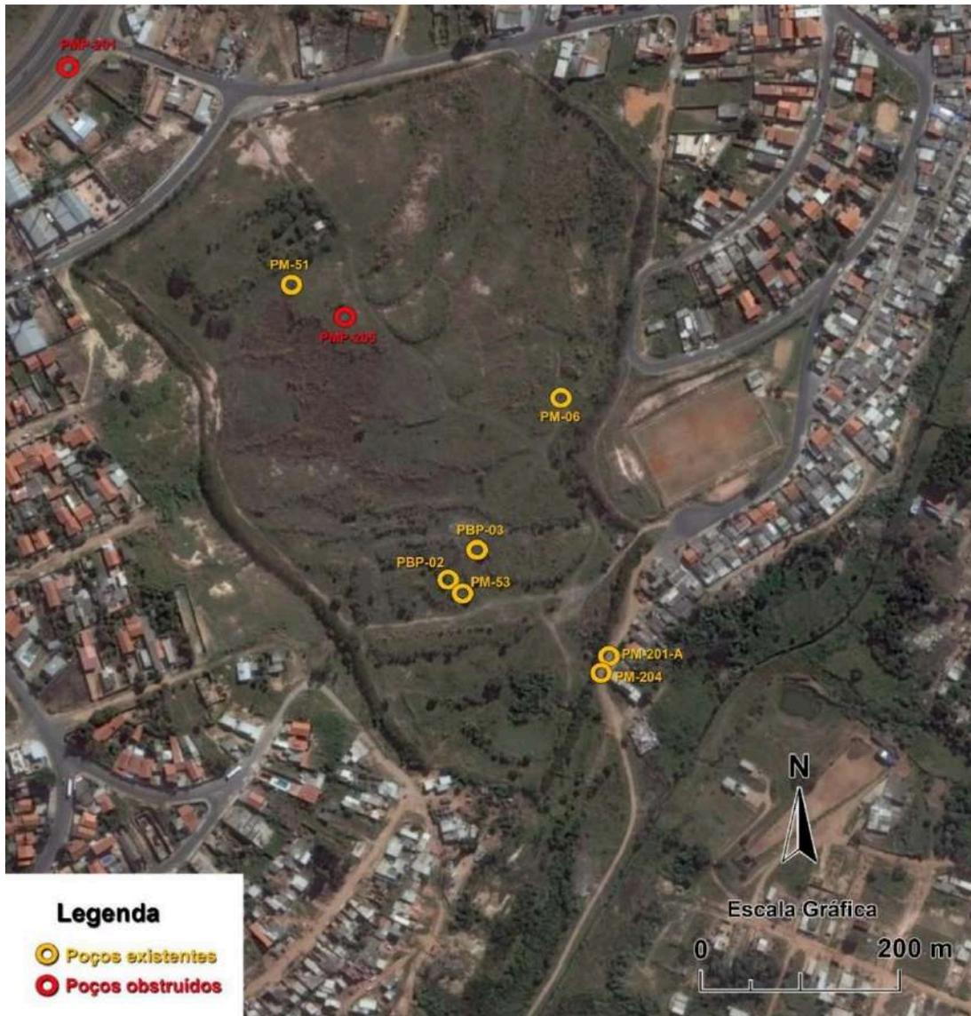
Figura 6.101: Localização dos Poços de Monitoramento as Águas Subterrâneas no entorno do Aterro Pirelli.
