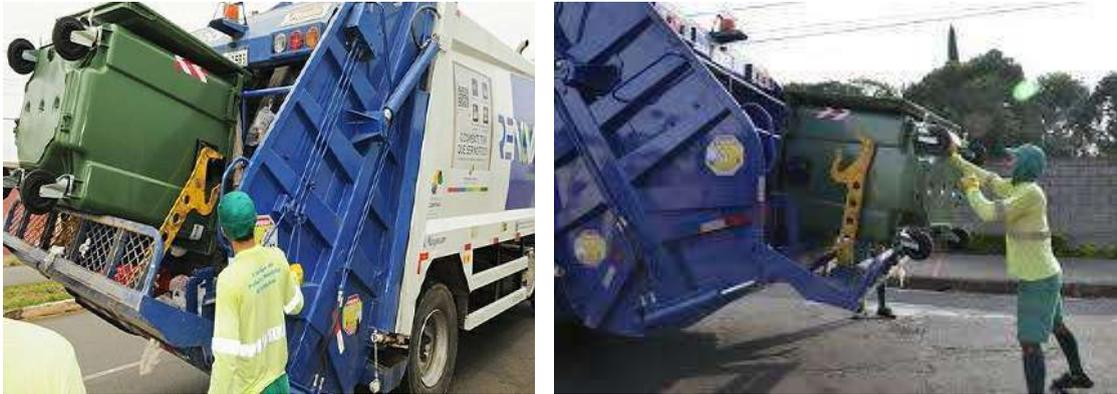
**Figura 6.5: Coleta de Resíduos Domiciliares do tipo mecanizada, detalhe do caminhão coletor e container**
