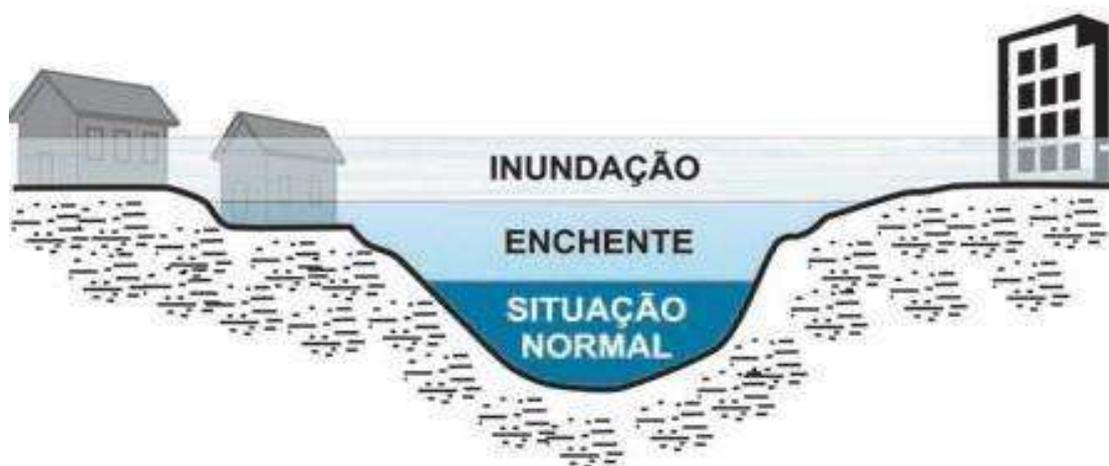
**Figura 7.3: Perfil esquemático do Processo de Enchente e Inundação**
