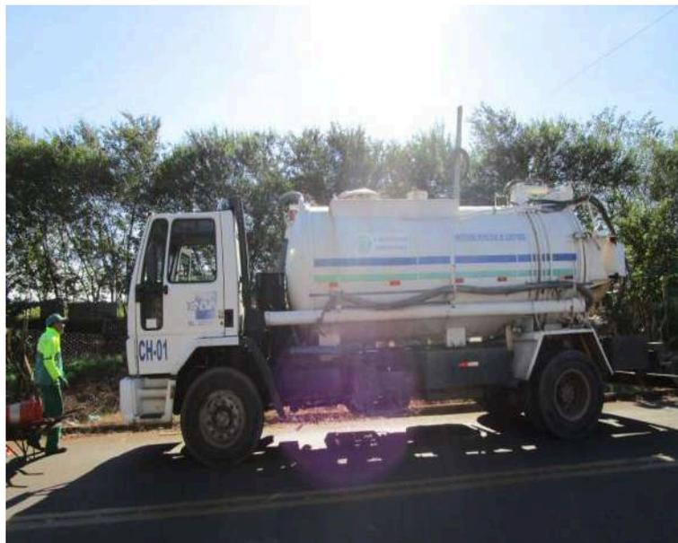
**Figura 6.35: Limpeza Mecanizada de Boca de Lobo**
