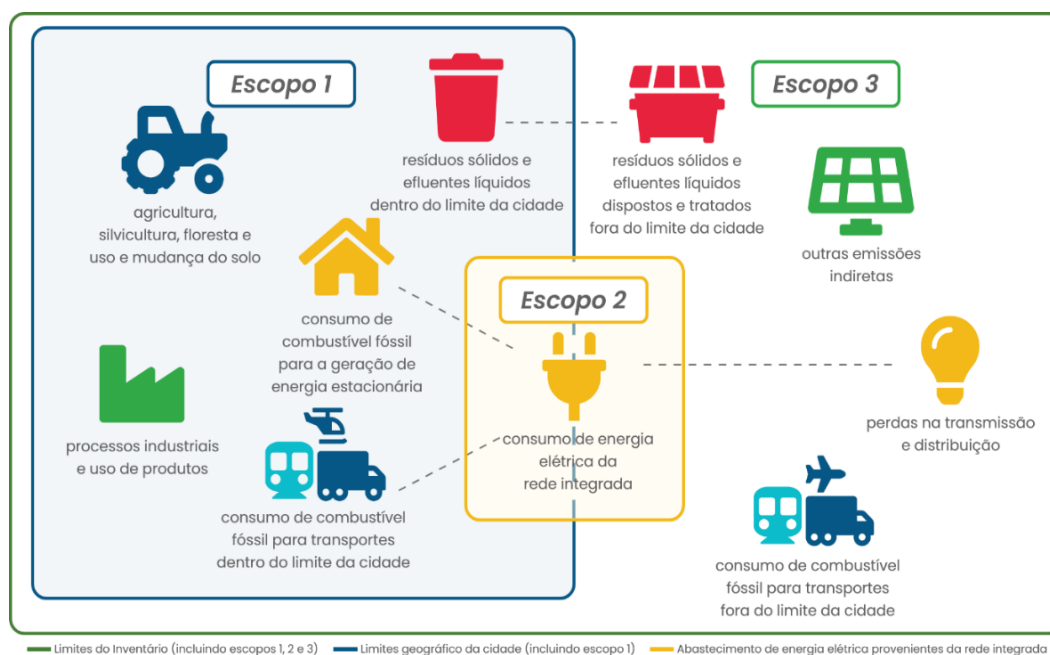
Figura 1 - Separação de atividades por escopo de emissão para método Basic+ do GPC
