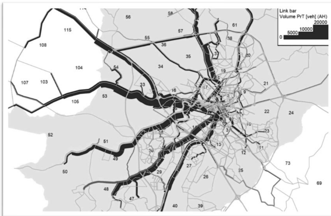
Figura 55 - Alocação Modo Coletivo – Cenário com BRT integrados pelo Perimetral Fonte: Parâmetro Engenharia
