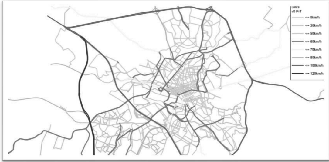
Figura 27 – Definição da Capacidade e Velocidade da Rede Viária Fonte: Parâmetro Engenharia
