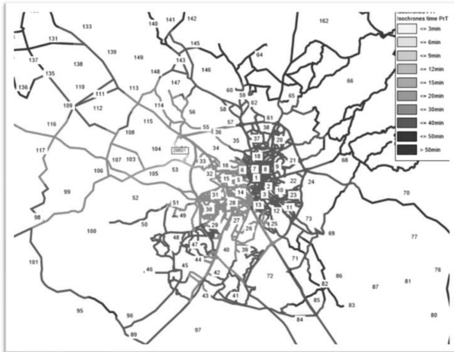
Figura 30 – Tempo de Viagem do Modelo de Simulação Fonte: Parâmetro Engenharia
