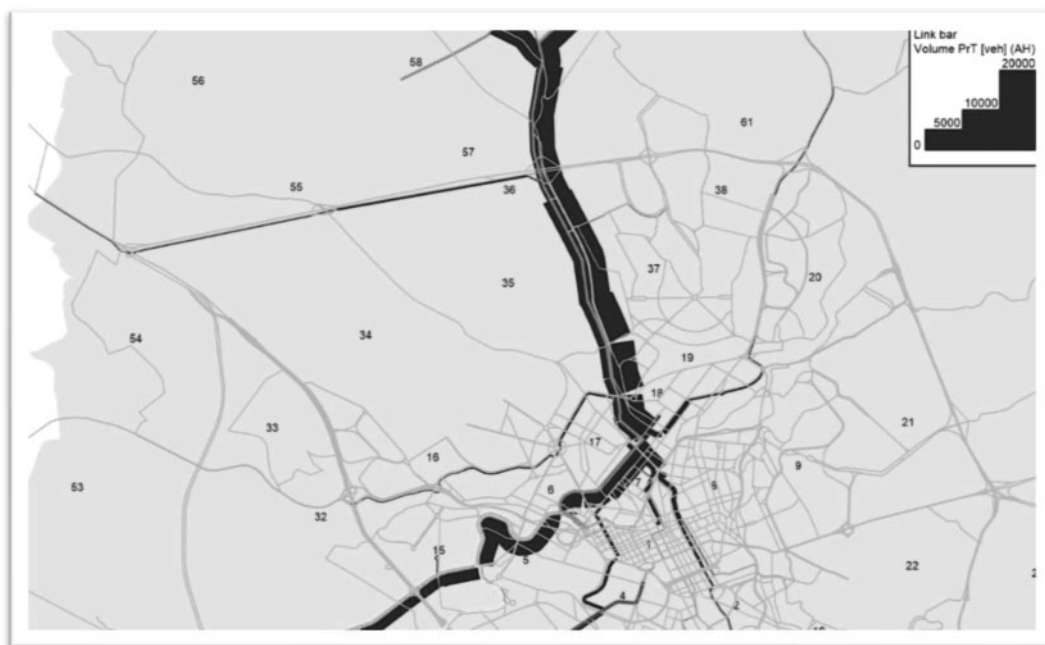
Figura 61 - Corredores BRT Ligação VLT Br. Geraldo Apenas Usuários Destes Sistemas Fonte: Parâmetro Engenharia
