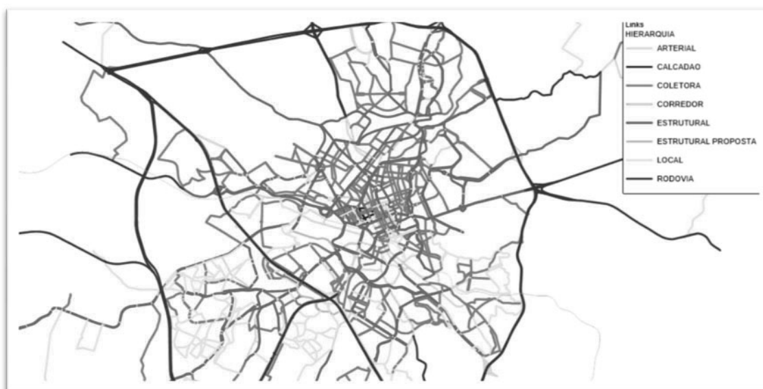
Figura 22 – Rede Viária Hierarquizada Fonte: EMDEC
