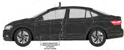
Figura 1.6. Identificação adicional lateral
